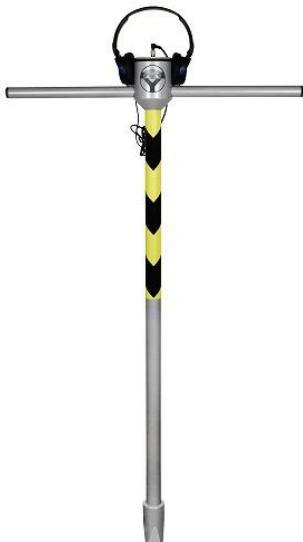
E' una particolare chiave di manovra unica nel suo genere che abbina alle funzioni meccaniche di normale utilizzo (apertura e chiusura delle saracinesche, idranti sottosuolo etc), le funzioni di verifica elettroacustica del perfetto funzionamento del meccanismo di chiusura della saracinesca, della PRE - LOCALIZZAZIONE DI PERDITE sulla rete e permette di testare attraverso apertura e chiusura ed il contestuale ascolto, la presenza di perdite su allacciamenti d'utenza.
