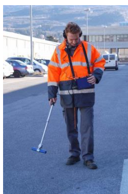
LOCALIZZAZIONE TUBAZIONI E CAVI INTERRATI CON METODO PASSIVO, ATTIVO GALVANICO ED INDUTTIVO
